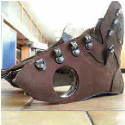
Vzorek boty zničený za účelem testování. Kruhový výřez byl použitý na zkoušku prodyšnosti.
