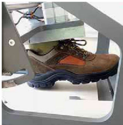
Zkouška přilnavosti podrážky, respektive odolnosti proti skluzu.
