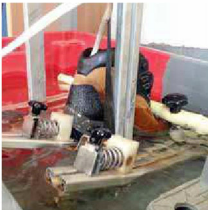
Dynamický test voděodolnosti simulující chůzi ve vodě.
