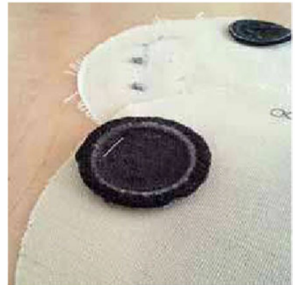
Vzorky podrážky po skončení testu odolnosti proti oděru.
